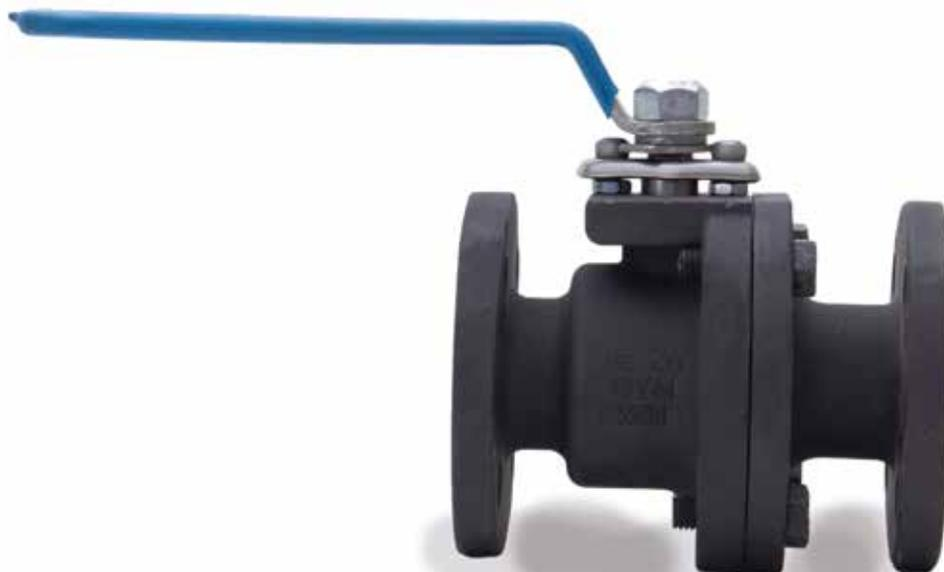
**UN CUARTO DE VUELTA** a la palanca es suficiente para operar la válvula de su posición de apertura total a la de cierre completo, las partículas abrasivas que pueda contener el fluido son literalmente barridas en el proceso de apertura o cierre de la válvula.
